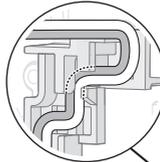
Retire el recubrimiento. Aprox. 9 mm
