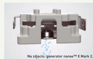
Urządzenie nie wymaga konserwacji ani wymiany elementów. W generatorze nanoe™ X nie ma filtrów ani nie wymaga ono konserwacji, ponieważ proces wytwarzania rodników przez tytanową elektrodę przebiega w ostrońie wody.
