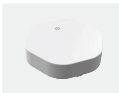
Czujnik wycieku wody Aktywacja dwóch wkładek pod korpusem czujnika następuje, gdy znajdzie się między nimi woda. Po wykryciu wody czujnik zgłasza zdarzenie do sterownika (i systemu BEMS).
