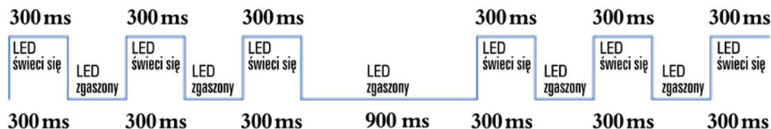
Arkusz 5: Kody usterkowe płyty układów sterowniczych — dotyczy wszystkich jednostek poza: 20K DUAL i 16K DUAL
