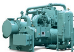
CYK HP Pompa ciepła typu woda-woda Podwójne sprężarki odśrodkowe, w układzie szeregowym / R1234ze Gorąca woda do 93°C Wydajność cieplna: 4000 - 10000 kW
