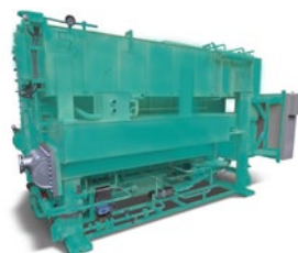
YHAP Jednostopniowa absorpcyjna Napęd parowy, gazowy lub przy użyciu gorącej wody / R718 Gorąca woda do 95°C Wydajność cieplna: 900 - 40000 kW
