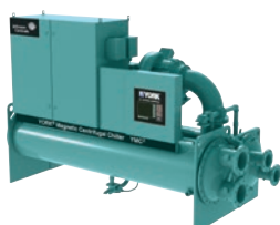
YMC² P. ciepła typu woda-woda Sprężarka odśrodkowa VSD łożyska magnet. / R513A Gorąca woda do 65°C Wyd. cieplna: 1600 - 3000 kW
