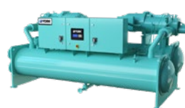
YVWH High Head HP P. ciepła woda-woda Spręż. śrubowa VSD / R1234ze Gorąca woda do 80°C Wydajność cieplna: 800 - 1600 kW
