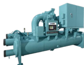
YK P. ciepła typu woda-woda Sprężarka odśrodkowa VSD / R513A Gorąca woda do 50°C Wyd. cieplna: 1000 - 9000 kW
