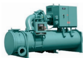
YK Pompa ciepła typu woda-woda Sprężarka odśrodkowa z napędem VSD / R1234ze Gorąca woda do 68°C Gorąca woda do 93°C (wys. ciśn.) Wydajność cieplna: 1000 - 9000 kW
