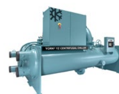
YZ P. ciepła woda-woda Sprężarka odśrodkowa VSD łożyska magnet. / R1233zd(E) Gorąca woda do 45°C Wydajność cieplna: 1000 - 6800 kW
